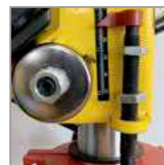
Graduated rod for drilling depth adjustment Varilla graduada para ajustar la profundidad de perforación
